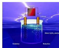
Pour réaliser la décomposition de certains liquides par le courant électrique, on utilise un électrolyseur. Cet appareil est constitué d'un cuve équipée de deux tiges verticales, en métal ou en graphite et qui ne doivent pas réagir avec le liquide contenu dans la cuve : ce sont les électrodes. L'un de ces électrodes est relié au côté positif du générateur d'électricité, l'autre est relié au côté négatif.
